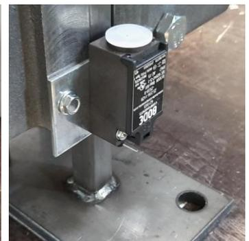
Schlaufseilschalter mit Montageblech
