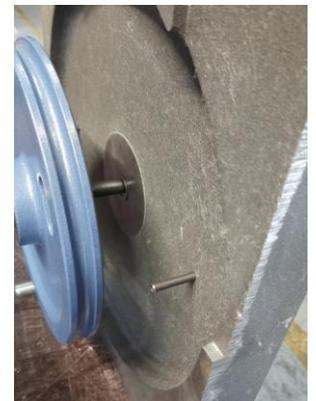
Kerbspannstifte als Abspringschutz und Spannrolle mit Passscheibe
